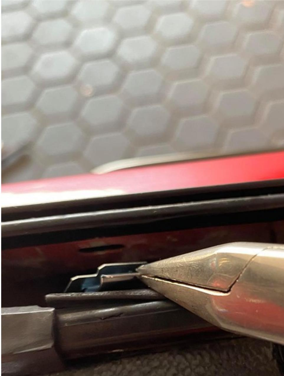
**Wenn alle Klammern an Position gebracht sind, neue Leiste an DreieckscheibengummiEnde anlegen und an B-Säulen Seite abmessen wo gekürzt werden muss. NICHT DAS Maß DER ALTEN LEISTE NEHMEN!**
