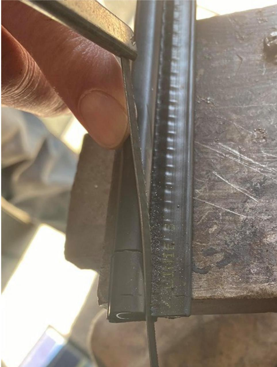
**Einbau der neuen hinteren gekürzten inneren Schachtleiste.**
