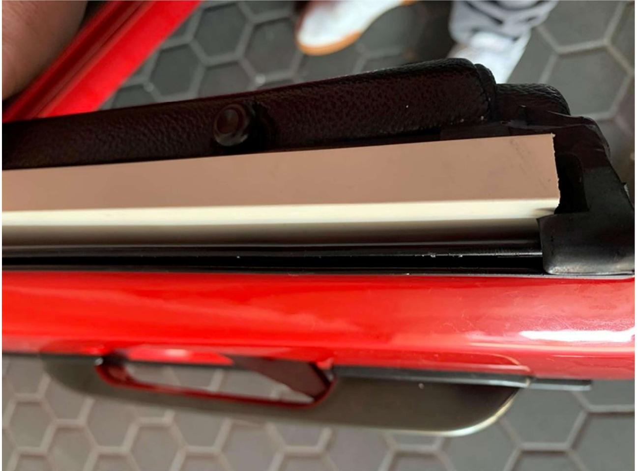
**Neue bereits gekürzte Fensterdichtung mit Silikon Spray einsprühen und an L-Profil Hilfsmittel zuerst Dreiecksscheibenseitig ansetzen. Dann langsam Richtung TürSchloss rein drücken und dabei drauf achten, dass die neue GummiLeiste UNTER den EndPilz der GummiTürdichtung geschoben wird.**
