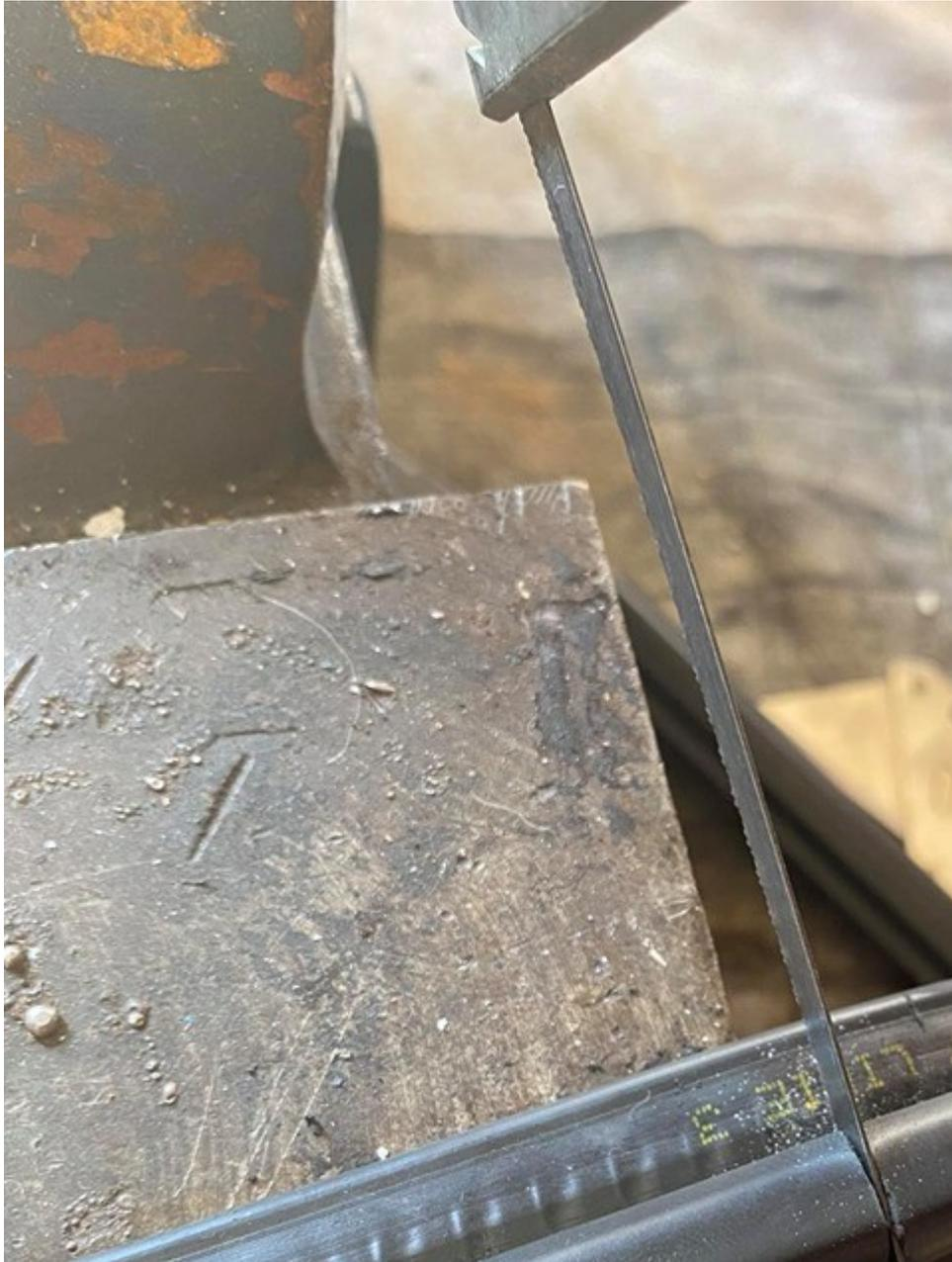
**An der Seite der Dreiecksscheibe kann mit der Metallfeile die neue Leiste etwas angefeilt werden, so dass eine kleine Stufe entsteht die sich dann perfekt an die Dichtung der Dreiecksscheibe anpasst.**
