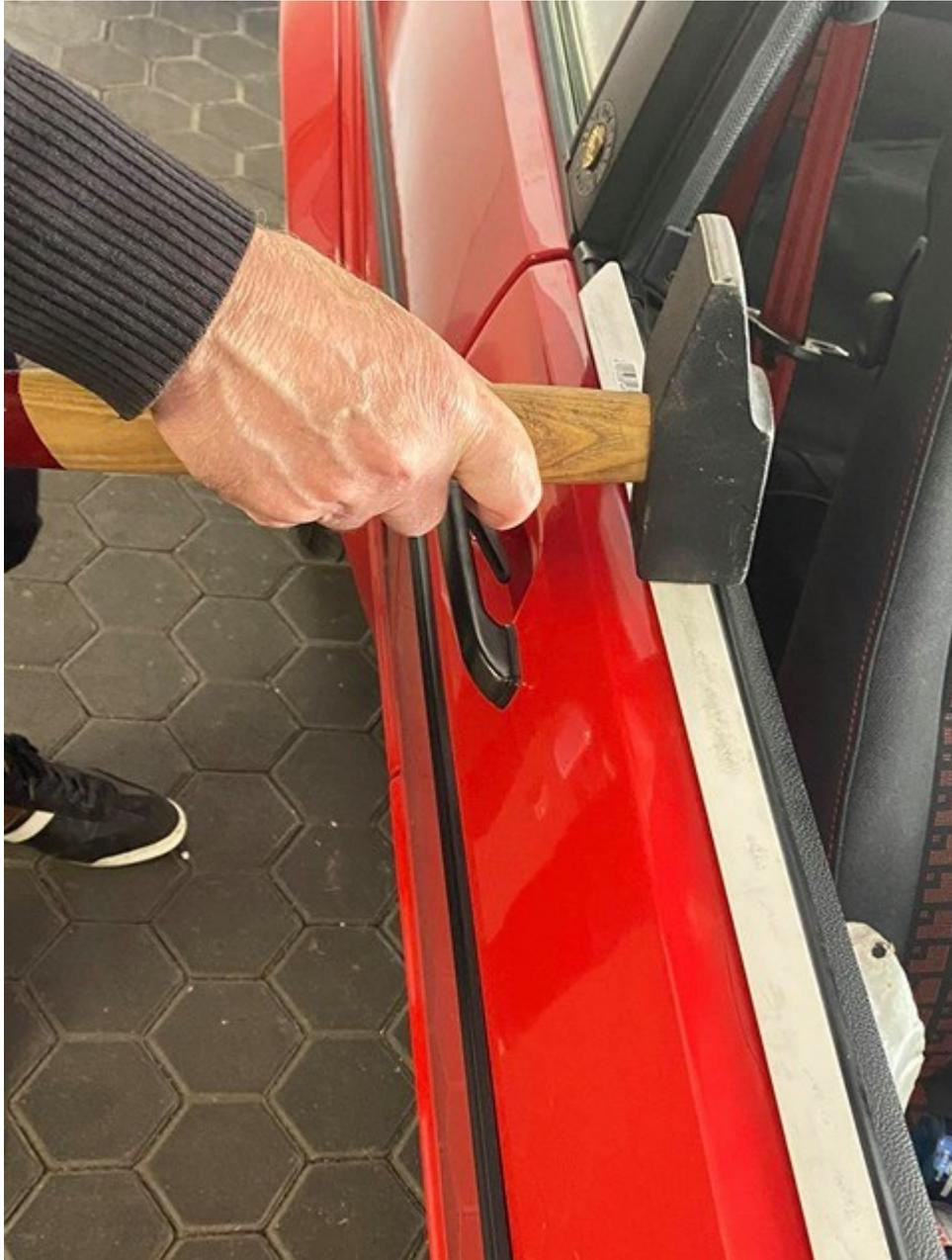
**Mit (Gummi)Hammer auf das L-Profil so lange vorsichtig aber mit Druck klopfen, bis sich die neue Dichtung komplett in die Klammern gesetzt hat. (Kann man in der Tür von innen reinblickend sehen) ALS TIP: bevor man auf der L-Profil klopft, die Tafeln so an Zierleiste anlegen dass man bei Abrutschen des Hammers nicht den Lack beschädigt.**
