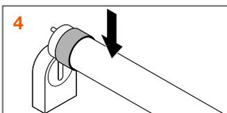
4 LEDTUBE T8, UN oder T5 HF einsetzen.
