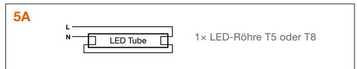
5A Verdrahtungsschema für einflammige Leuchten
