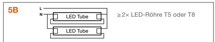
5B Verdrahtungsschema für zweiflämmige Leuchten
